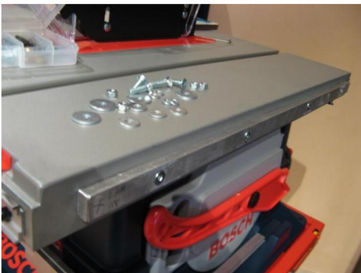
corrispondenza con la parte rinforzata (vedi fig.6) del retro piano del banco sega. Una volta effettuati i fori sulla barra in alluminio, ho bloccato con delle pinze la barra nella posizione dovuta tale che, adagiata la piastra della fresatrice sul supporto in alluminio questa risulti a filo col piano del banco.
