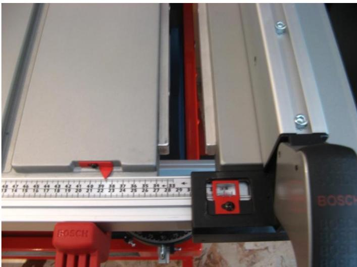
Ed ecco il carrello scorrevole del piano rimontato e le due barre in alluminio assemblate, pronte a fare da **supporto alla piastra della fresatrice.**
