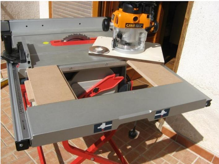
Adoperando dell'MDF da 18 mm. ho costruito le due prolunghe da inserire alle 2 estremità della piastra, al fine di raccordare tutto il vano di alloggio piastra con il piano del banco sega.
