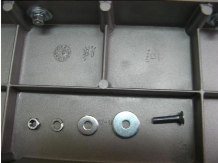
In questa foto si vede la posizione di uno dei fori sul frontale del banco, attraverso il quale viene avvitata la barra di supporto alla piastra della fresatrice.
