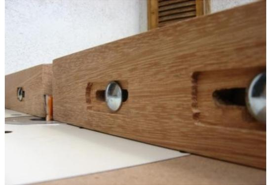
Ho utilizzato dei perni, della stessa sezione di quelli in dotazione con la guida laterale ma, + lunghi di circa cm.4, in modo da agganciare le contro guide realizzate, utilizzando i dadi a farfalla già in dotazione.
